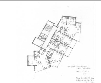
Hotel apartamento da Torre (1971): Conjunto que integraria uma torre e casas de pátio em banda. A torre, cuja verticalidade contrasta com a horizontalidade do plateau em que assenta, visava constituir um marco na paisagem e poupar o coberto vegetal existente. A torre abria-se em leque para sul nascente, não só para o disfruto de vistas, mas também para levar o "sul" a todos os apartamentos, na linha da investigação feita por Alvar Aalto.
